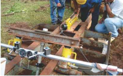
Cilindros TRC-303 sendo usados para testes em estruturas metálicas
