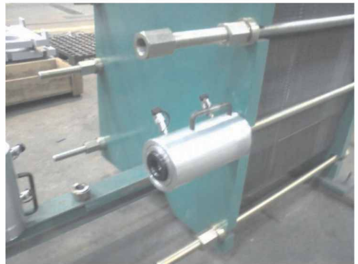
TRRH-1006 utilizado para fechamento de trocador de calor a placa;
